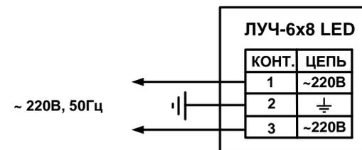
Рис.1. Схема подключения.
