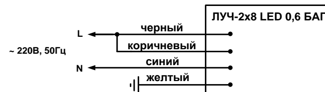
Рис.1. Схема подключения светильника постоянного действия.
