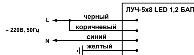
Рис.1. Схема подключения светильника постоянного действия.
