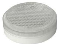
Исполнение 4, диаметр 150мм ЛУЧ-12-С 34/64, ЛУЧ-24-С 34/64, ЛУЧ-36-С 64, ЛУЧ-220-С 34/64, =12/=24/~36/~220В, 3/6Вт, 460/800Лм 4000К (3000/5700 К под заказ)
