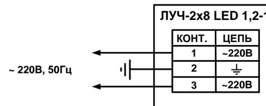
Рис.1. Схема подключения.
